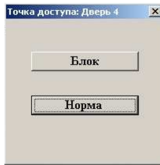
Рис. 4.14 Панель управления точкой доступа (перевод из разблокированного режима в нормальный или заблокированный режимы)
